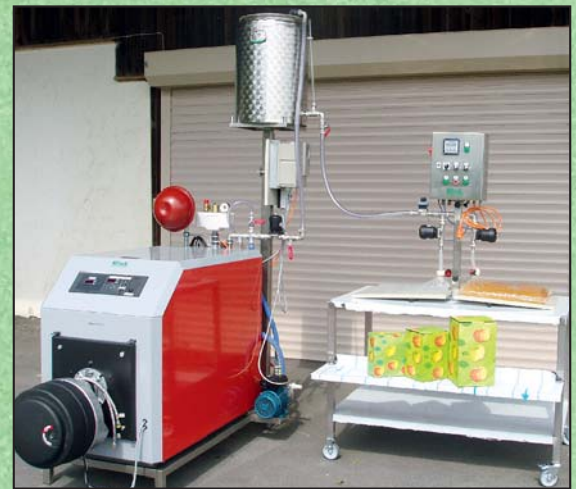
PK 1100 RWT mit wärmeisoliertem Vorlaufbehälter. Saftpumpe mit Drehzahlregler.
