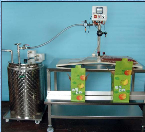
DL-Pasteur 13,5 kW, auf 27 oder 40 kW erweiterbar. Abfüllung mit Bag in Box Dosierautomat mit automatische Untertemperatursicherung; für Saftzulauf Pumpe erforderlich.
