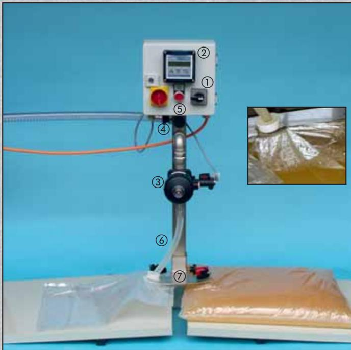
Dosierautomat EF 600 (Einfüllstutzen mit Schutzkappe)
