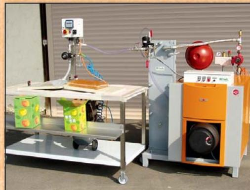
Durchlauferhitzer mit Plattenwärmetauscher
