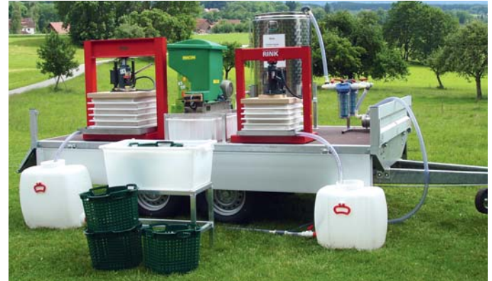
Mobile Kelterei mit Abfüllanlage bis 200 Ltr./Std.
