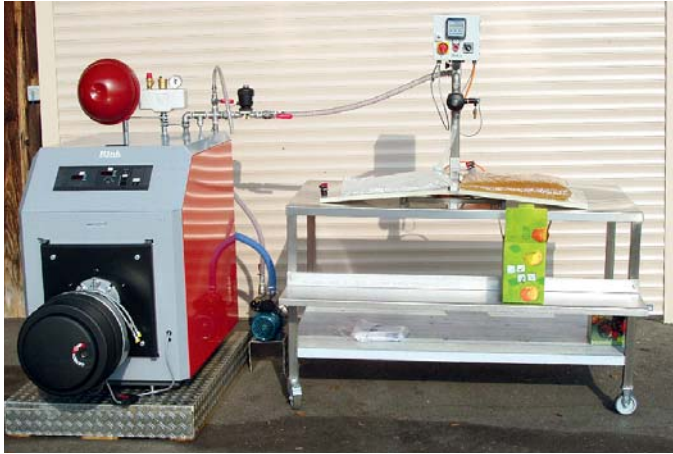
PK 850 RWT mit Röhrenwärmetauscher im Kesselwasser mit Bag in Box Dosierautomat und Arbeitstisch fahrbar.
