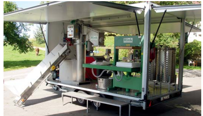
Mobile Kelterei, Förderband, Waschanlage/Mühle/Packpresse/Abfüllung
