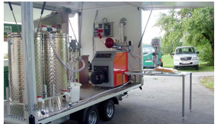
Mobile Kelterei mit Abfüllanlage 450–500 Ltr./Std.
